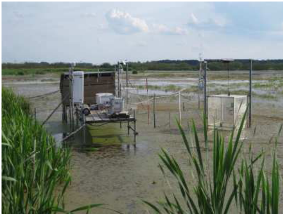
Messstation zur Bestimmung der Freisetzung von klimaschädlichen Gasen im wiedervernässten Polder Zarnekow-Upost – Fördermaßnahme 323d (Foto: vTI 2009).
